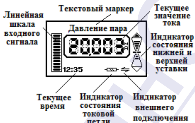
Рисунок 3 – Окно текущего значения выходного тока прибора
