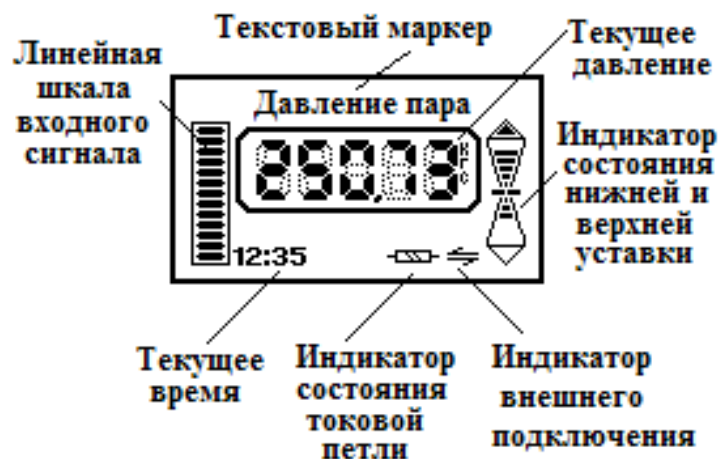
Рисунок 2 – Окно текущего значения давления прибора
