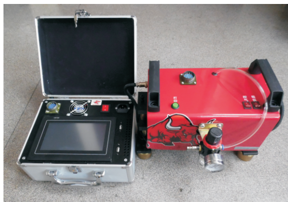
Маркировочная головка 150-50 в комплекте с автономным контроллером RDC-A
