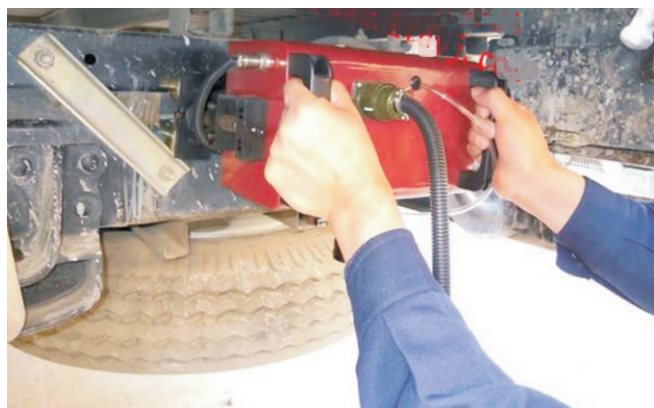
Нанесение маркировки на раму автомобиля с помощью маркиратора RDP 150-50
