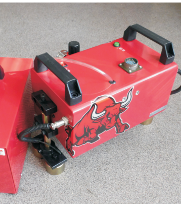
Маркировочная головка 150-50 в комплекте с контроллером RDC-PC
