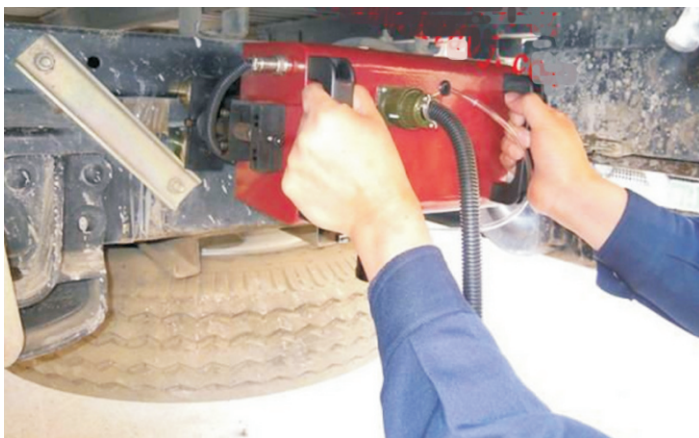
Нанесение маркировки на раму автомобиля с помощью маркиратора RDP 120-40
