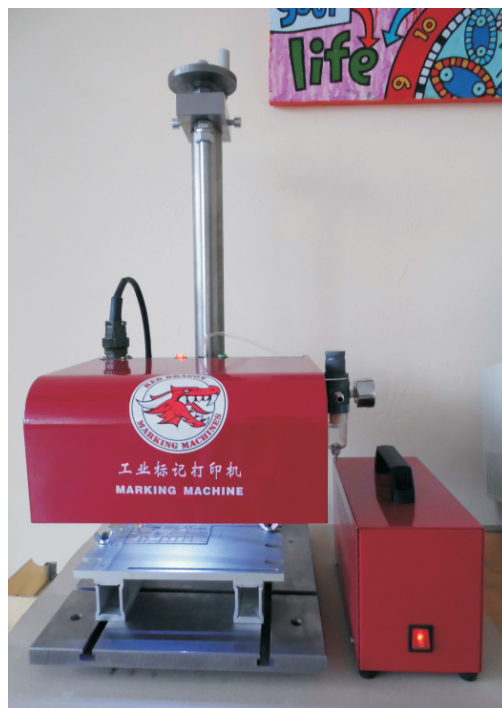
Стационарная система RDB-PC с маркировочным окном 200x150 мм
