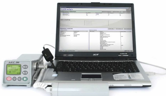
Рисунок 4 Комплекс для формирования отчетов в сборе – ДКС-96 с пультом УИК-05 и адаптером для передачи данных на ПК и ноутбук
