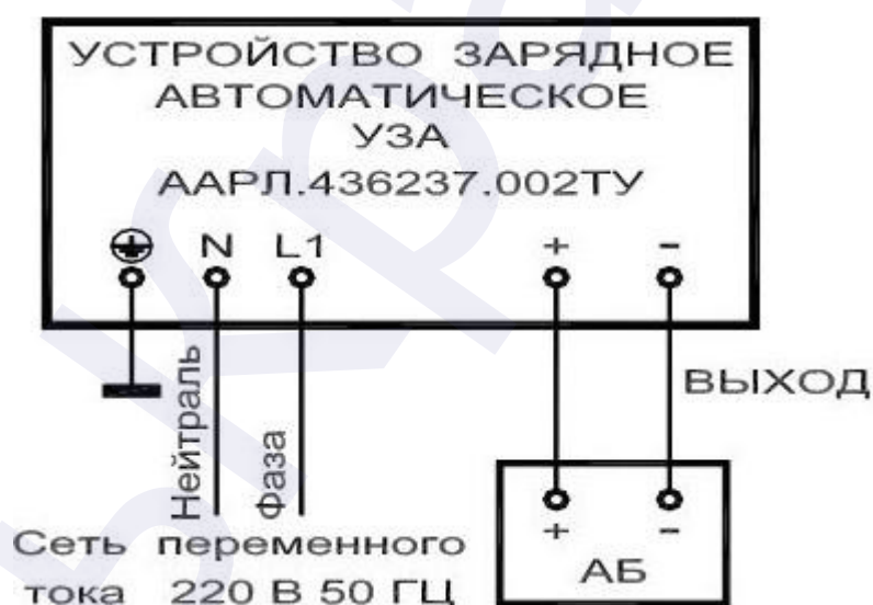
Рисунок 2 -Схема соединения УЗА
